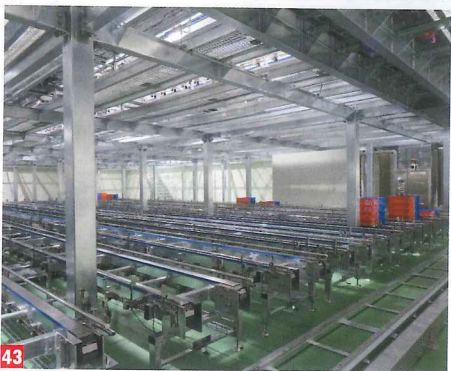
42 トンネル型フリーザーで包装済みの商品を急速冷凍する。でんぶんの劣化を防ぎ風味も閉じ込められるなど品質保持に寄与。計画生産が可能となり、働き方改革の実現にもつながる／43 番重に入れられた冷凍パンは、-18℃の立体冷凍庫に番重ごと保管される／44 パレットで保管する冷凍庫も設置／45 出荷バースは5カ所。そのほか、冷凍専用の出荷バースもある
