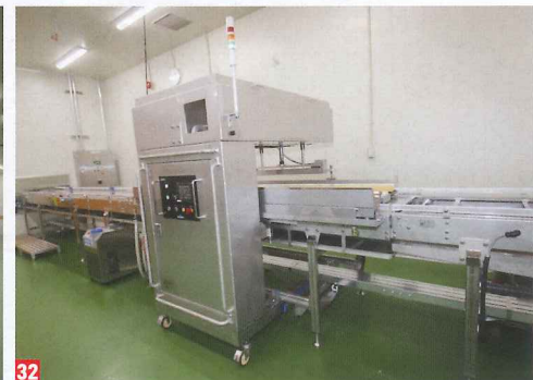
30 鉄板に移された生地は第二次発酵室に搬送される / 31 第二次発酵室では室温38℃前後、湿度80%前後で、約60分発酵させる。発酵後の生地は少し膨らんでいる / 32 つや出し機でパンの表面に黄身を塗る / 33,34 トネルオーブンで焼成する。あんパンの焼成温度と時間は190℃で約12分
