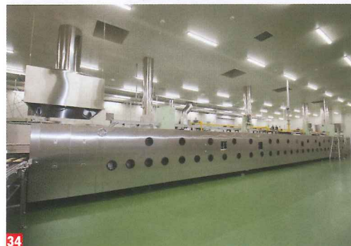
30 鉄板に移された生地は第二次発酵室に搬送される / 31 第二次発酵室では室温38℃前後、湿度80%前後で、約60分発酵させる。発酵後の生地は少し膨らんでいる / 32 つや出し機でパンの表面に黄身を塗る / 33,34 トネルオーブンで焼成する。あんパンの焼成温度と時間は190℃で約12分
